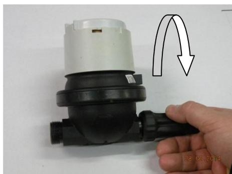
1-Vérifier la présence du joint torique et l'état de la portée de joint sur le compteur (propre, pas de choc...)
